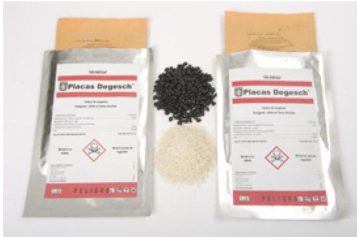
La Placa Degesch es una matriz plástica inerte, semirrígida y cubierta con papel permeable a la humedad y a la fosfina, El ingrediente activo de las Placas y Tiras Degesch\* es fosfuro de magnesio al 56%, el cual, en contacto con la humedad ambiental, libera fosfuro de hidrógeno (fosfina, PH<sub>3</sub>). La Tira Degesch es una serie de 20 Placas interconectadas lo que permite agilizar la aplicación cuando se deben hacer tratamientos a grandes volúmenes.
